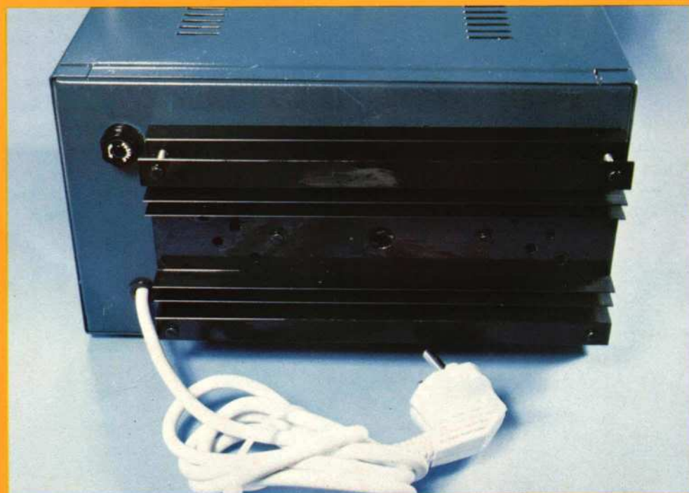
Afb. 13. De twee eindtransistoren zijn hier aan de buitenzijde van de kast (achterwand) gemonteerd. De toevoerdraden moeten van voldoende dikte zijn om geen spanningsverliezen te krijgen.
