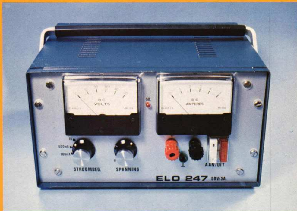
Afb. 14. Het front van de voedingskast kan eenvoudig en overzichtelijk worden uitgevoerd. Wrijfletters maken het geheel professioneel van uiterlijk.
